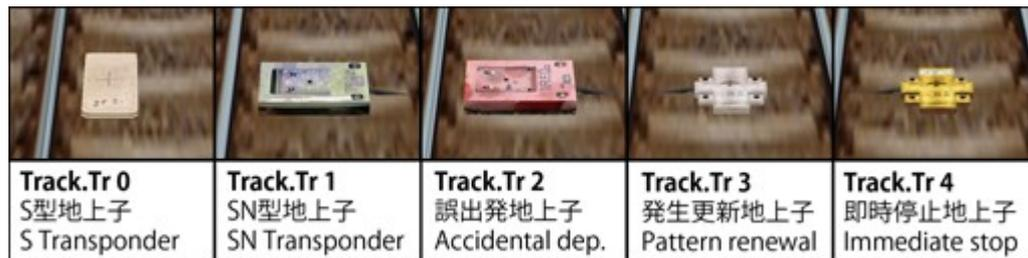
0 : Un transpondeur de type S utilisé par ATS-S. Habituellement placé à 600m en face d'un signal.
